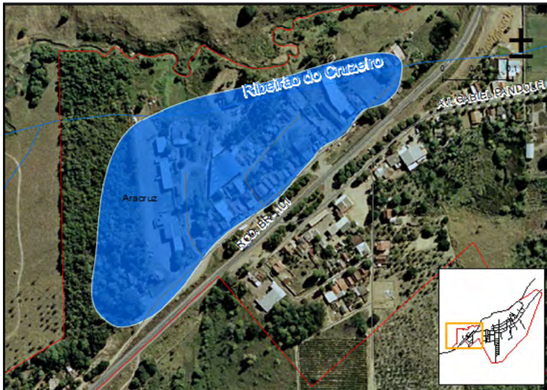
Figura 9.8.3-2: Área sensível a inundação pelo Ribeirão do Cruzeiro a montante da BR-101, (366828 S, 7823326 E). Fonte: Adaptado de IEMA (2008) & GEOBASES (2014).
