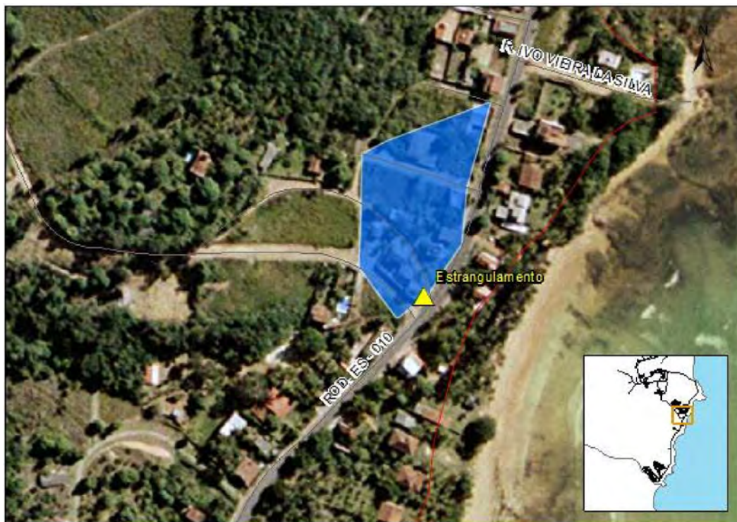
Figura 9.8.6.6-4: Áreas sensíveis a alagamento localizadas próximo ao cruzamento da Rodovia ES-010 com a subida alternativa para o Bairro Itaparica (380486 S, 7790500 E). Fonte: Adaptado de GEOBASES (2014) & IEMA (2008).
