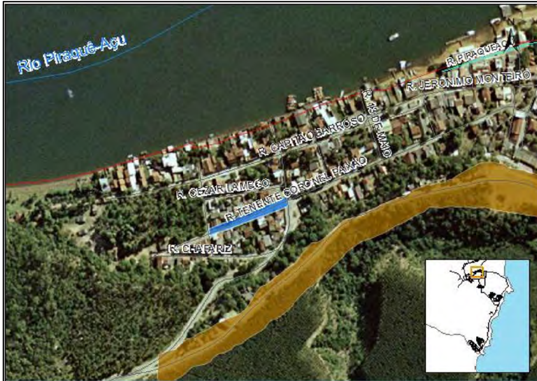
Figura 9.8.6.5-3: Área sensível a alagamento (em azul) na rua Tenente coronel Paixão e áreas com riscos de deslizamento em marrom (378750 S, 7793054 E). Fonte: Adaptado de GEOBASES (2014) & IEMA (2008).
