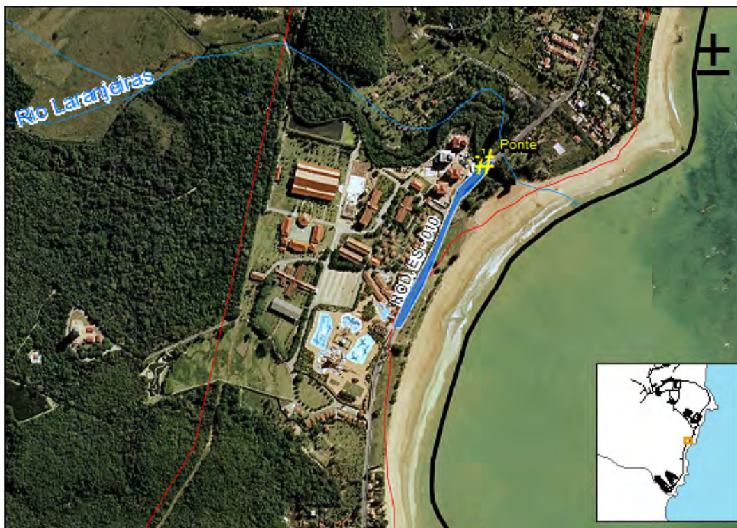
Figura 9.8.6.7-2: Área sensível a alagamento da Rodovia ES-010 no quilometro em frente ao Sesc de Aracruz, em Praia Formosa (380069 S, 7789632 E). Fonte: Adaptado de GEOBASES (2014) & IEMA (2008).
