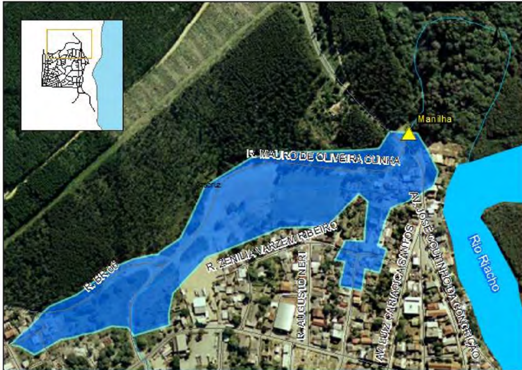
Figura 9.8.5-5: Área sensível a alagamento no acesso norte da Barra do Riacho (388901 S, 7807843 E). Fonte: Adaptado de IEMA (2008) & GEOBASES (2014).
