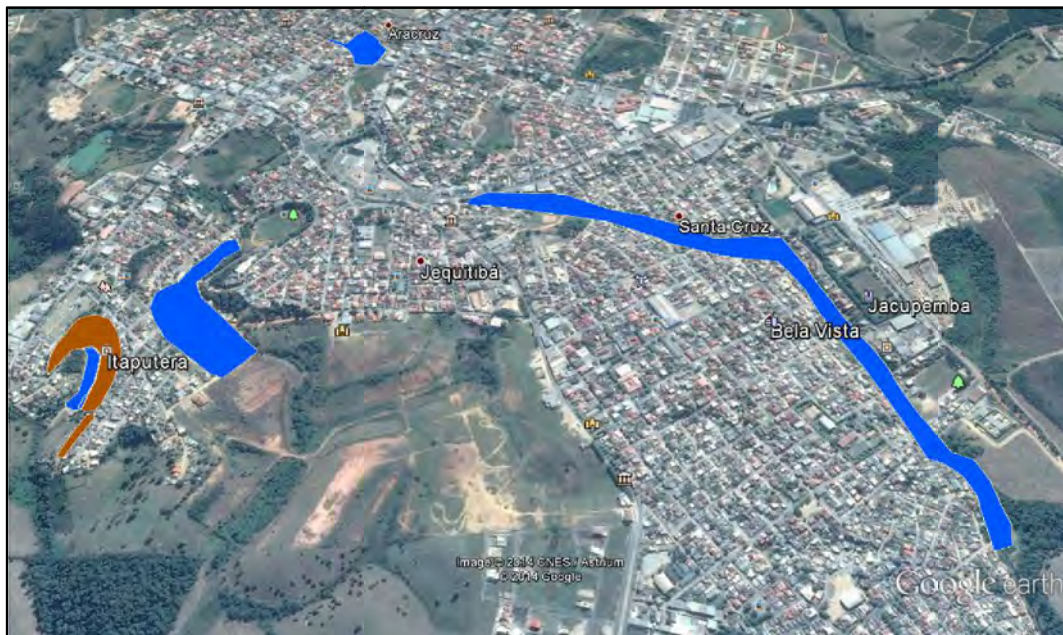
Figura 10.1.1.1-13: Sede do Município – Mapeamento de áreas com comprometimento na Drenagem Urbana e Pluvial. Mapa gerado na reunião de leitura comunitária na Sede. Fonte: Equipe técnica e social Diamon – PMD de Aracruz (2014).
