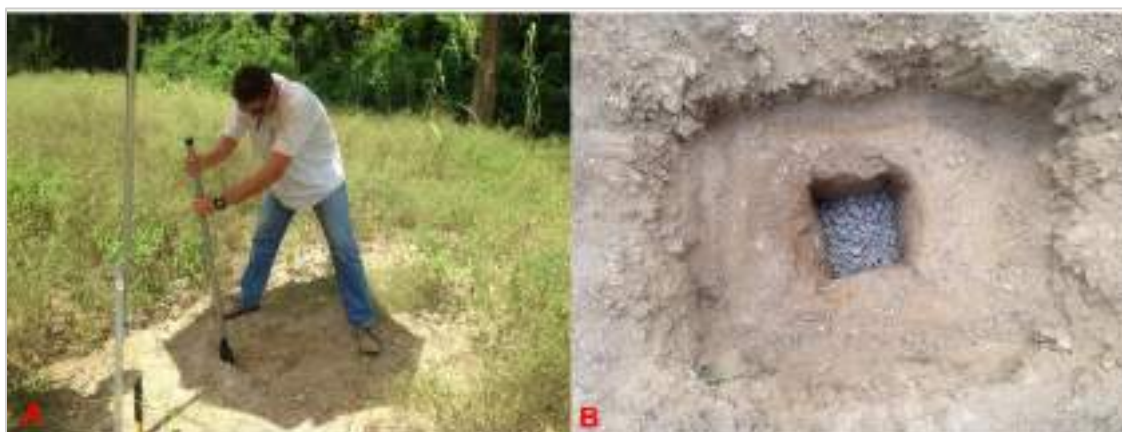
Figura 45 - a) Realização do buraco pelo técnico e b) Furo feito com brita no fundo para o cálculo da permeabilidade. Coordenadas no ponto E 327228m; N 7805120m (UTM Sirgas2000).
