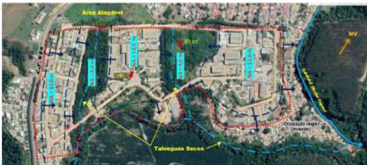
Figura 47 - Indicação de profundidades dos níveis de águas subterrâneas nas áreas.
