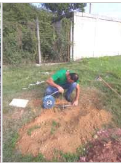
Figura 39 - Medição da profundidade do NA na sondagem ST 02, no tabuleiro (platô).
