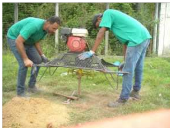
Figura 17 - Sondagem a trado mecanizado na posição ST02 (tabuleiro).
