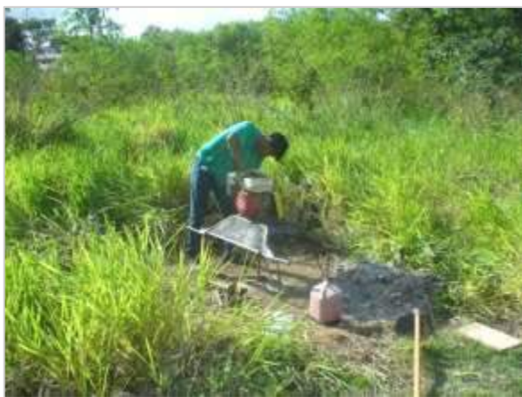
Figura 16 - Sondagem a trado mecanizado na posição ST01 (fundo de vale).
