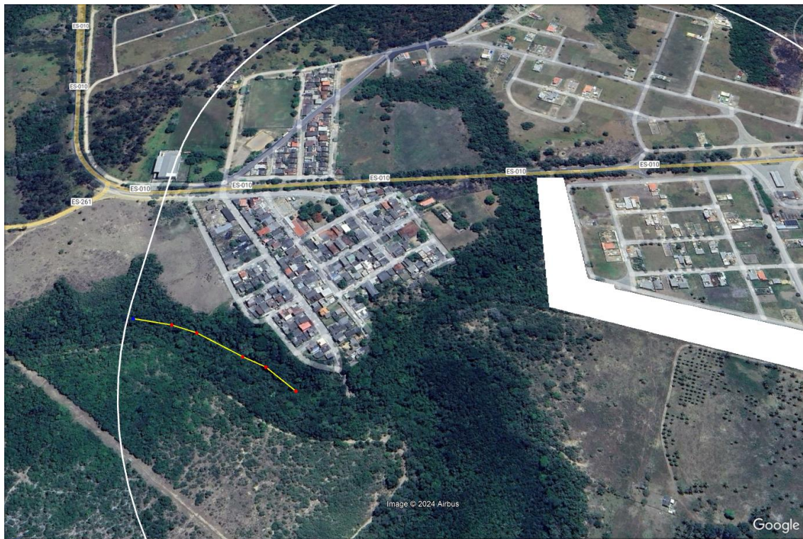
Imagem 64: Curso d’água identificado no AID, destacado em amarelo, distante mais de 300 m do limite da área do terreno, em destaque pelo polígono branco.
