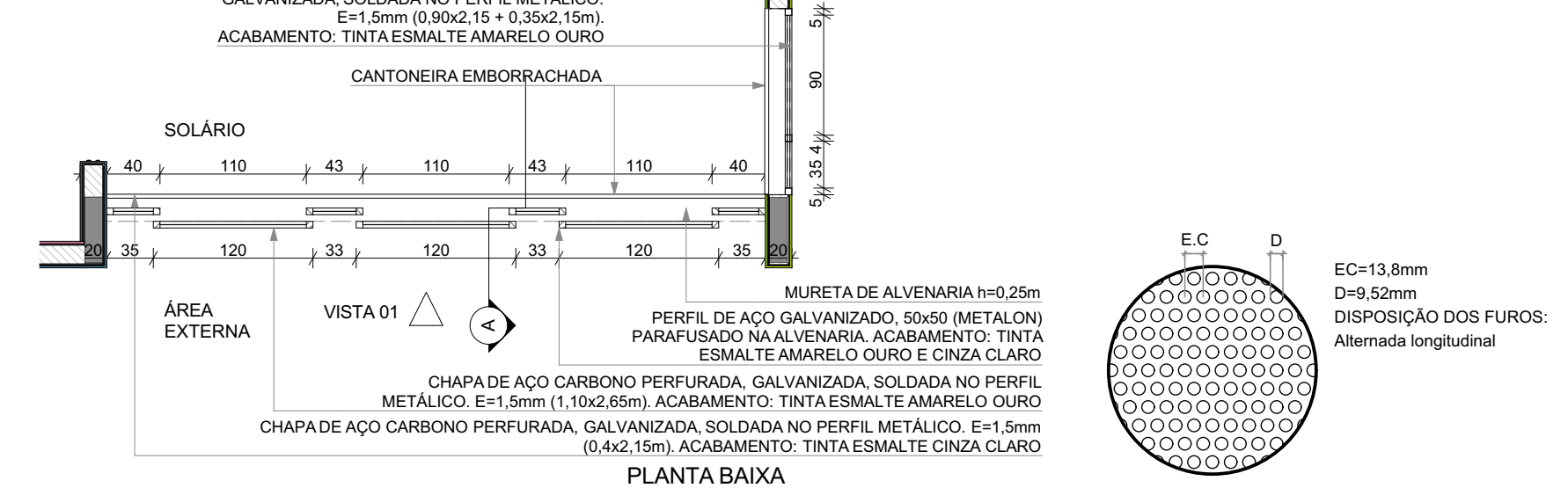
7 DETALHE 5: GUARDA-CORPO METÁLICO ESCAL:1:50
