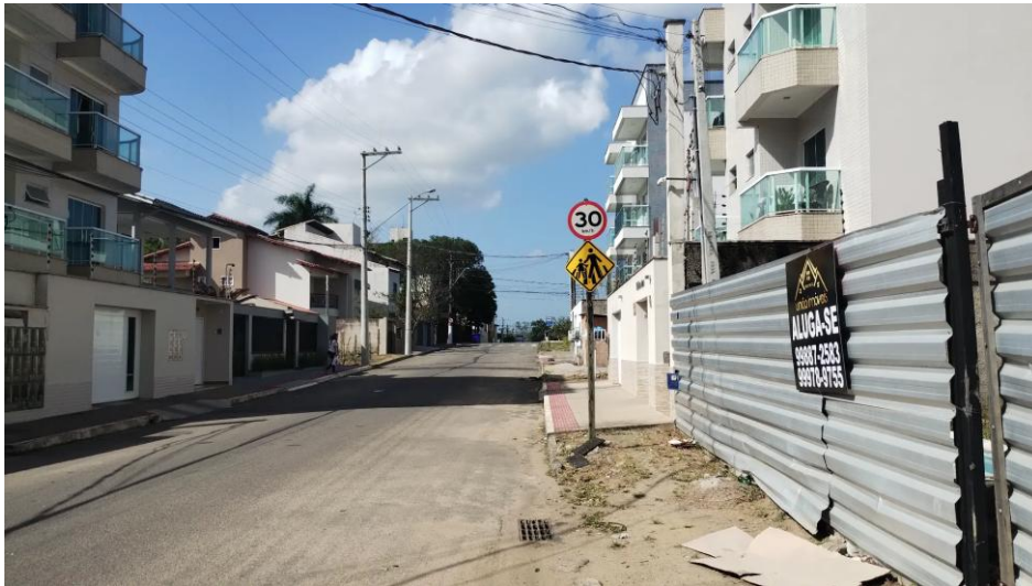
Figura 47: Rua Flor de Liz: sinalização vertical regulamentar de limite de velocidade e placa indicativa de travessia de pedestres. Fonte: Regini, Marcelo. Novembro, 2025.
